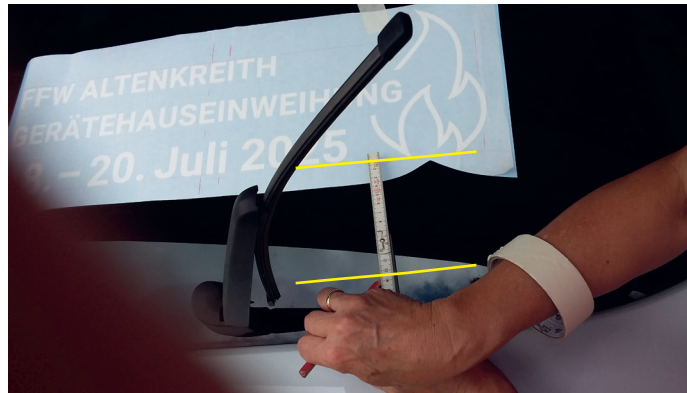
Folienplot an der Heckscheibe horizontal 1 cm außer Mitte nach links versetzt und vertikal links und rechts im gleichen Abstand zu den Heizlinien in der Scheibe platzieren; mit Kreppband fixieren
